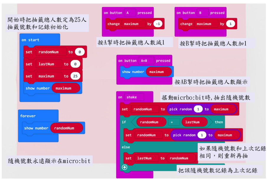
圖四：學生製作抽籤器的流程圖及程式
