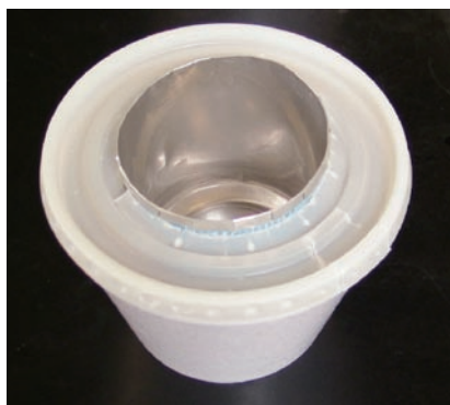
圖一：由一個鋁罐及一個大的即棄聚苯乙烯杯製成的自熱裝置，發熱的化學品可放於鋁罐或聚苯乙烯杯內。
