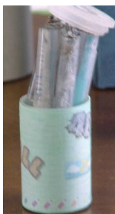
圖二：電池組由四個電池串聯組成，並裝在菲林筒裡。
