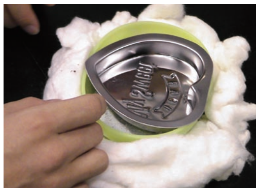
圖二：用塑膠肥皂盒及心型金屬碟製成的自熱裝置。
