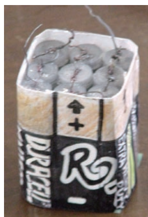
圖三：電池組由九個電池組成，電壓介乎2 - 2.5 V。
