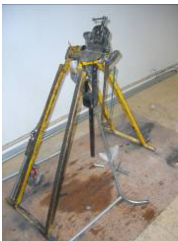
圖 2.16 手工操作屈曲工具，有圓形控制表面以及軋輥
