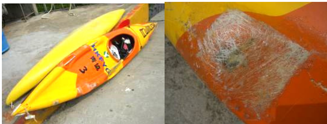
圖 1.46 玻璃纖維強化塑料製成的獨木舟
