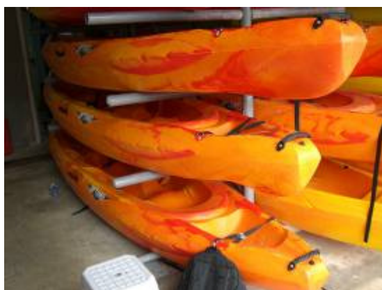
圖 2.12 注塑成形法造成的獨木舟
