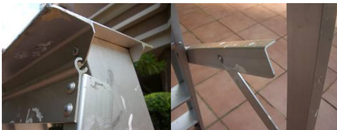
圖 2.42 可以容易擠壓成的橫切面形狀
