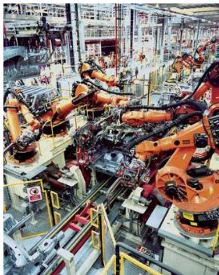
圖 3.18 彈性製造系統工作單元 / 汽車生產
