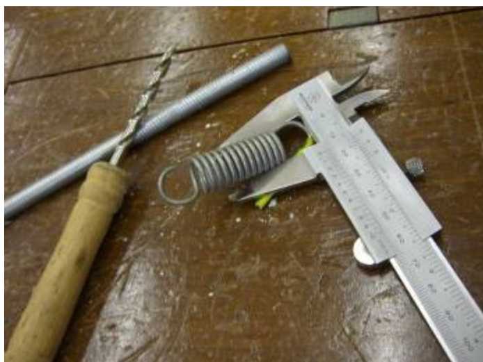
圖 2.64 利用卡尺來進行精確的測量
