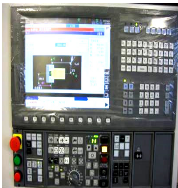
圖 3.3 切割過程的在電腦屏幕顯示的模擬情況
