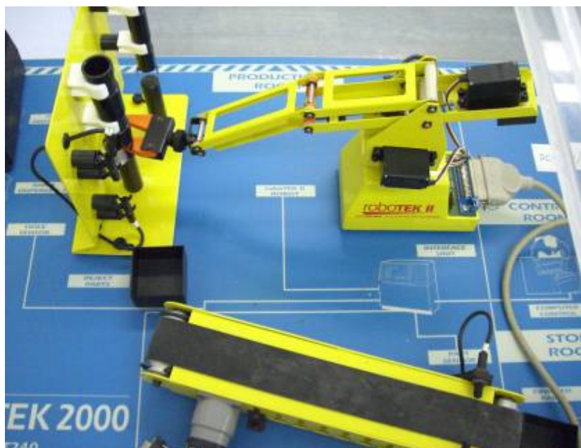
圖 3.11 利用機械臂作取放操作的模型
